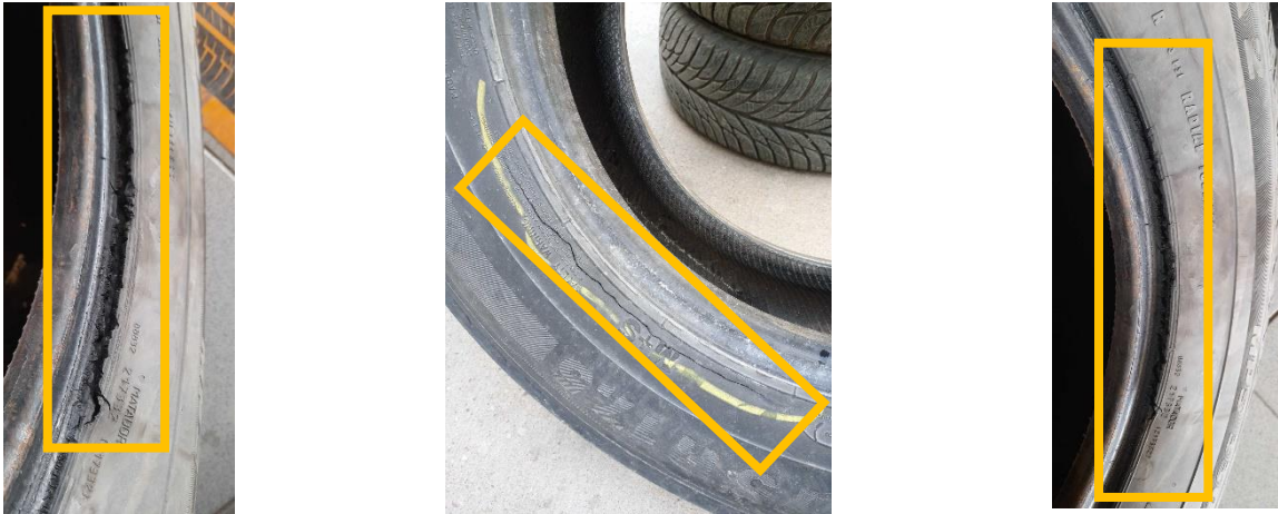
Topuk Dibinde Çatlama
